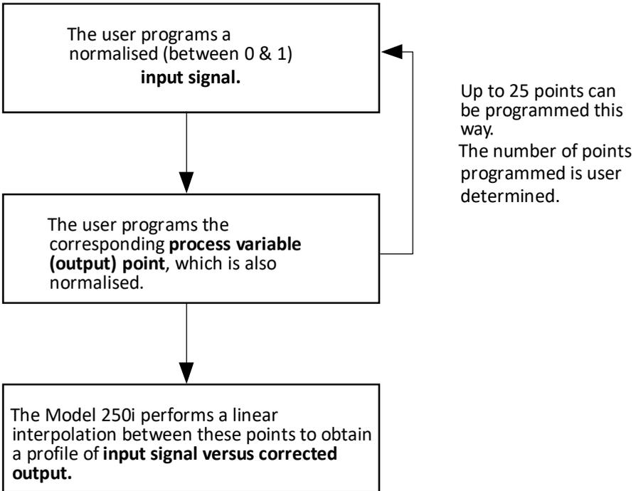
**DETERMINING THE NON-LINEAR CORRECTION TABLE**
